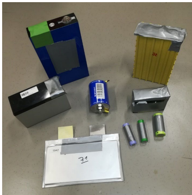
Figuur 12: Verschillende vormen van Li-ioncellen. Het is duidelijk dat er op celniveau een grote variatie is aan vorm en grootte. Bron: VITO.
