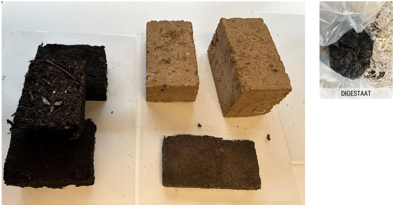
Figuur 7 eerste resultaten van bakstenen op basis van digestaat met toevoeging van additieven zoals kalk, klei en koffie
