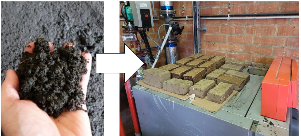
Figuur 6 eerste resultaten van bakstenen op basis van digestaat
