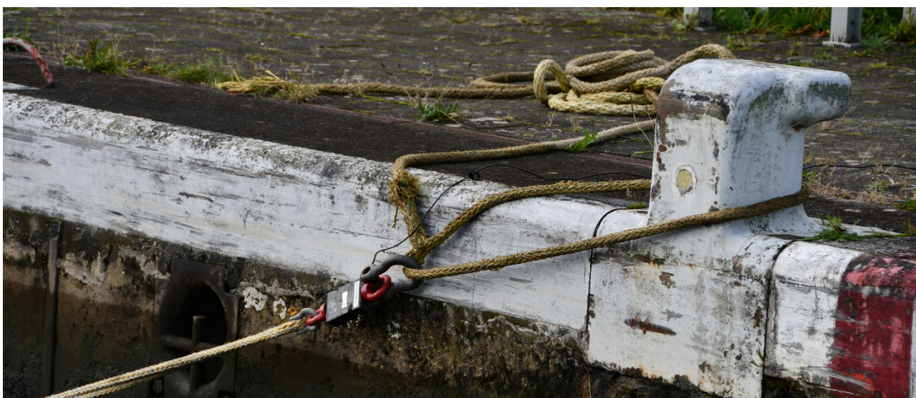
Figuur 12 – Krachtenopnemer bevestigd tussen meettouw en bolder
