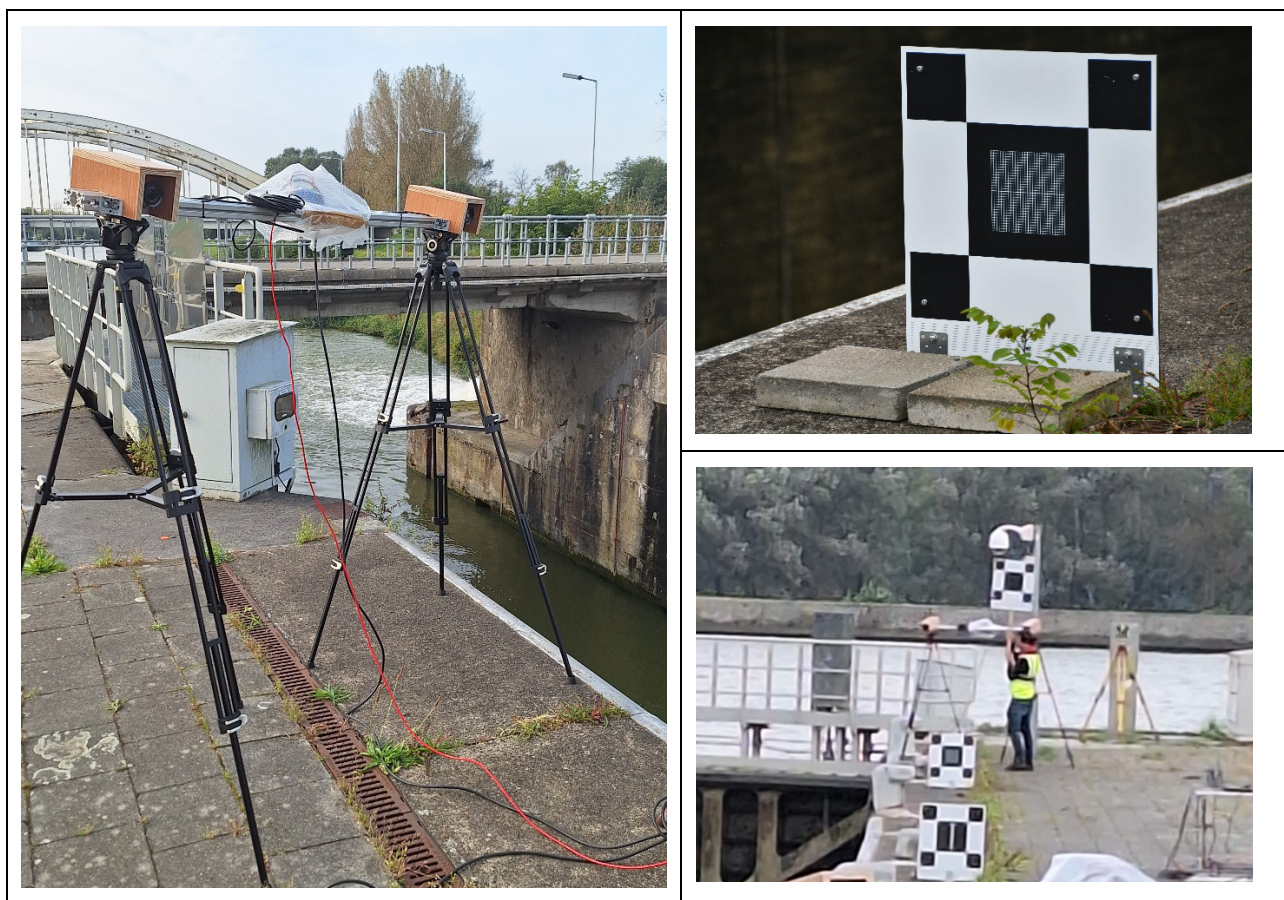
Links: stereopaar; rechtsboven vast dambordpatroon; rechtsonder kalibratie met bewegende dambordpatroon
