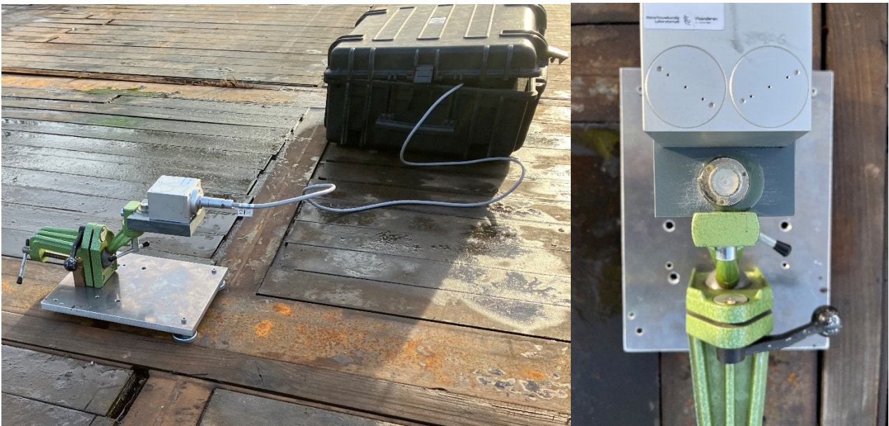
Figuur 11 – Opstelling inclinometer gemonteerd op Zulu I tijdens uitvoeren PoC Iv-Infra
